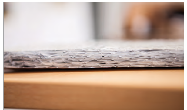
Bild 2: Vertikalschnitt mit Schichtaufbau der Luftpolsterfolie
